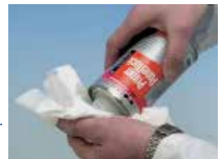
Voorbehandeling achterzijde met Primer PanelTack
